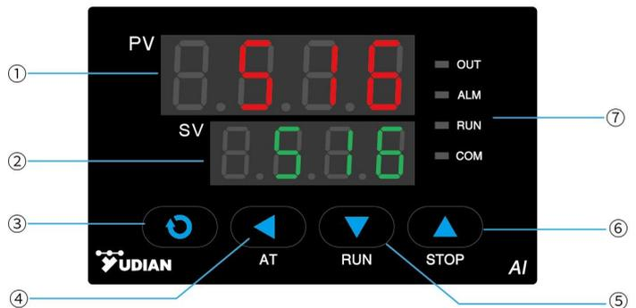
仪表上电后进入基本显示状态，此时仪表上、下显示窗分别显示测量值（PV）和给定值（SV），下显示窗还可交替显示以下字符表示状态：①“orAL”，表示输入的测量信号超出量程；②“HIAL”、“LoAL”、“HdAL”或“LdAL”时，分别表示发生了上限报警、下限报警、偏差上限报警、偏差下限报警；③“StoP”表示处于停止状态；“HoLd”表示暂停状态和准备状态。
