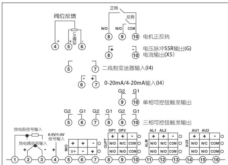
注：线性电压量程在 1V 以下的由 2+、3- 端输入，0~5V 及 1~5V 的信号由 4+、3- 端输入。4~20mA 线性电流输入可用 250 欧变为 1~5V 电压信号，然后从 4+、3- 端输入，也可在 MIO 位置安装 I4 模块从 7+、6- 端输入；或直接从 5+、6- 接二线制变送器。不同分度号的热电偶采用的热电偶补偿导线不同，采用内部自动补偿模式时，补偿导线应直接接到仪表后盖的接线端子上，中间不能转成普通导线，否则会产生测量误差。
