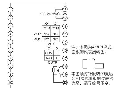
本图顺时针旋转 90 度后为 F1 模式面板的仪表接线图, 端子编号不变。
