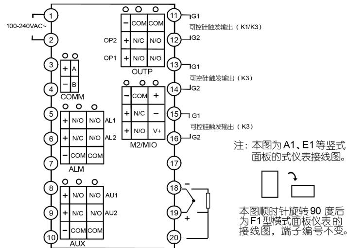
本图顺时针旋转90度后为F1型横式面板仪表的接线图，端子编号不变。
