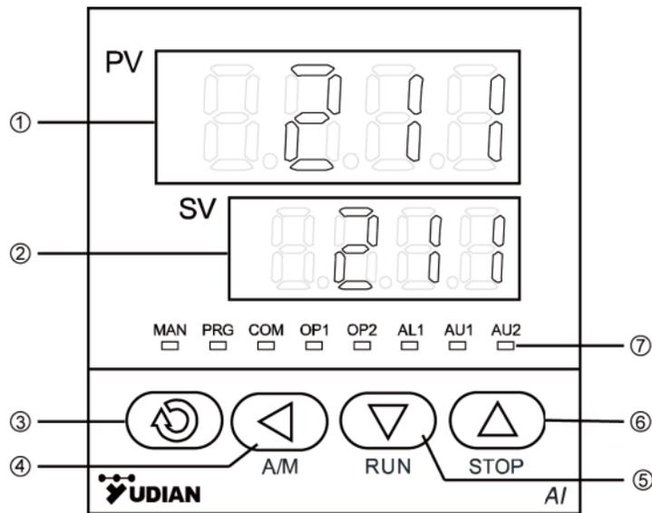
仪表上电后进入基本显示状态，此时仪表上、下显示窗分别显示测量值（PV）和给定值（SV），下显示窗还可交替显示以下字符表示状态：“orAL”，表示输入的测量信号超出量程。
