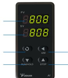
设置参数方法：当参数锁未锁上时，按 (①) 键并保持约 2 秒钟，等显示出参数后再放开。再按 (①) 键，仪表将依次显示各参数，如回路 1 输入规格 InP1、参数锁 Loc 等等。对配置好并锁上参数锁的仪表，
